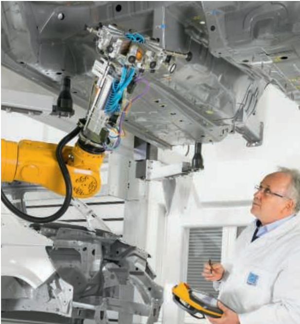
Im Robotikzentrum in Frankfurt entwickeln die Faist ChemTec-Experten automatisierte Montagekonzepte, die auf den Produktionsprozess beim Kunden abgestimmt sind.
